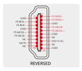
注: 这个选项用于匹配不同的I2S接口标准, 使用前请检查信号源的接口定义。
